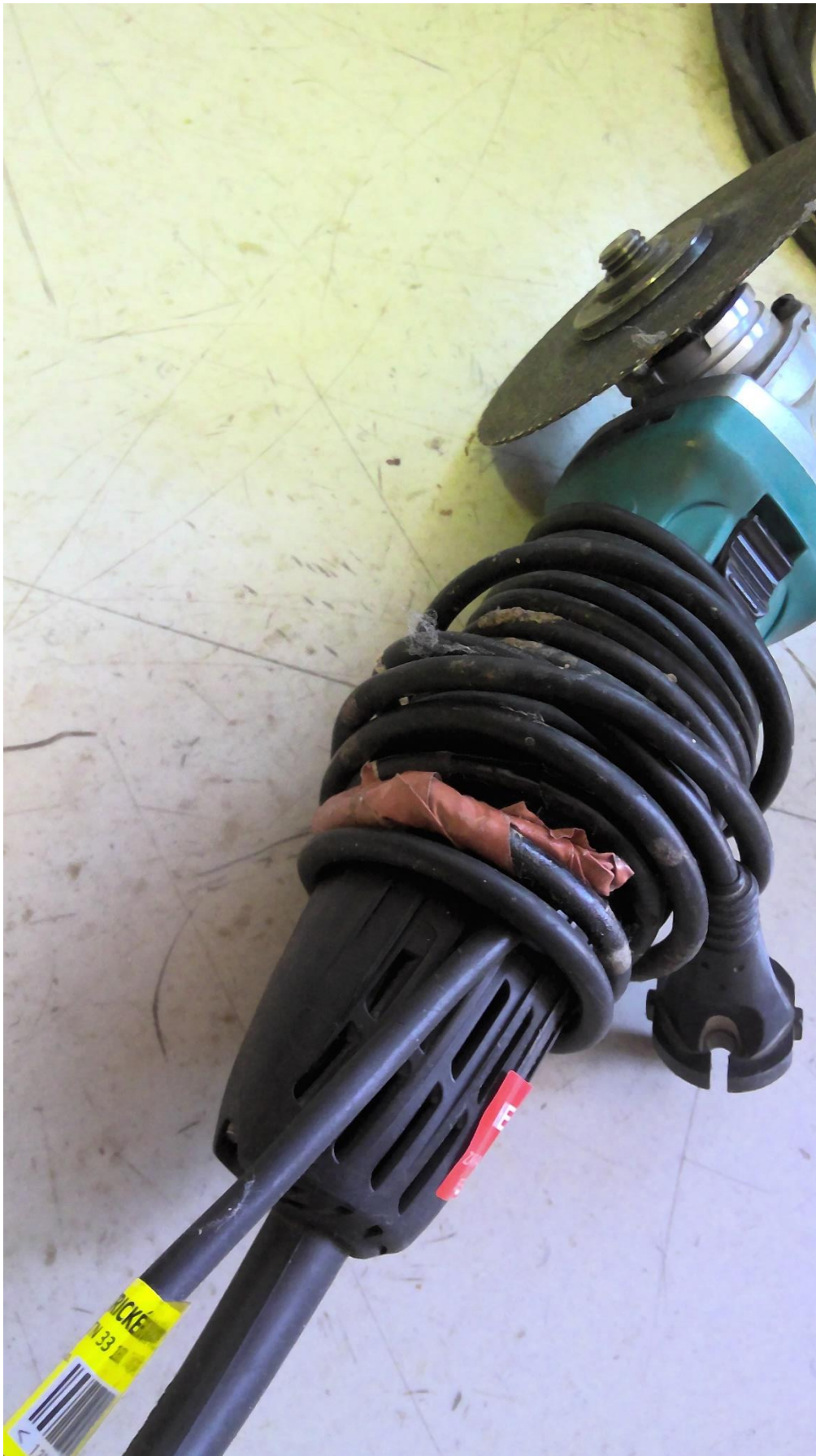
Rev.č. 1444, UHLOVÁ BRÚSKA, ÚDRŽBA – Poškodená izolácia
